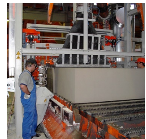
Aeroc AS tehase sisevaade, massiivide lõikamine
