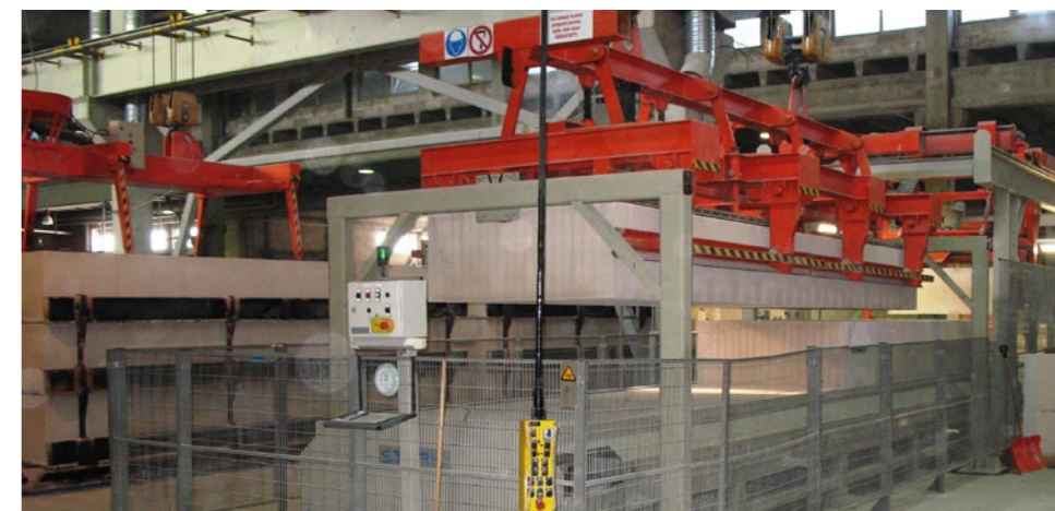
Aeroc AS tehase sisevaade, massiivi tõstmine pakkeliinile
