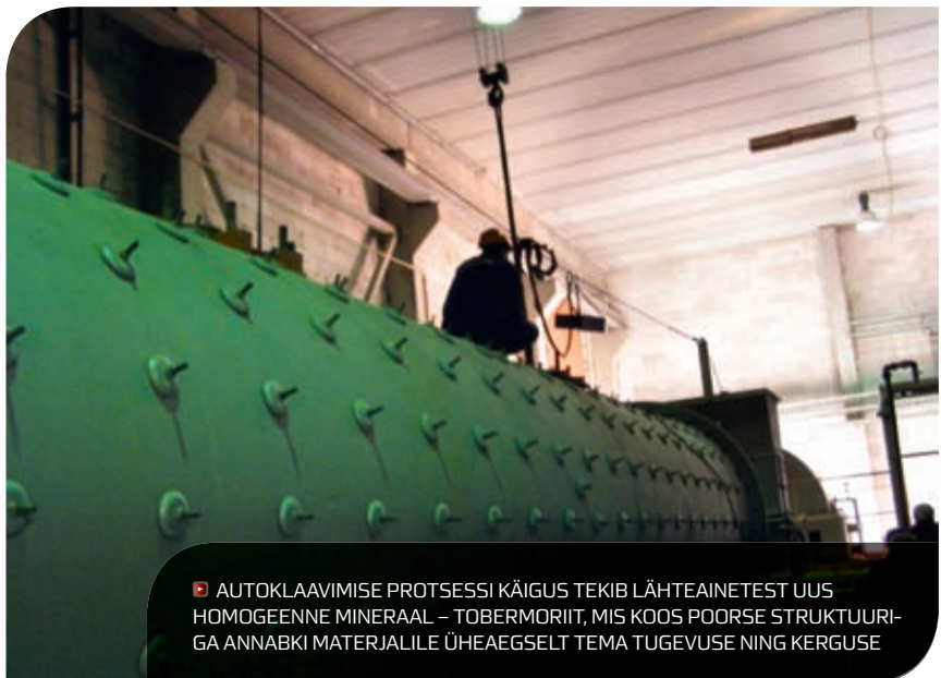
► LÕPLIKU TUGEVUSE SAAVUTAVAD AEROCI TOOTED AUTOKLAAVIDES (“LEIVAÄHJUS”) NENDE TERMISEL TÖÖTLEMISEL AURUGA KÕRREL TEMPERAATUURIL JA RÖHUL
