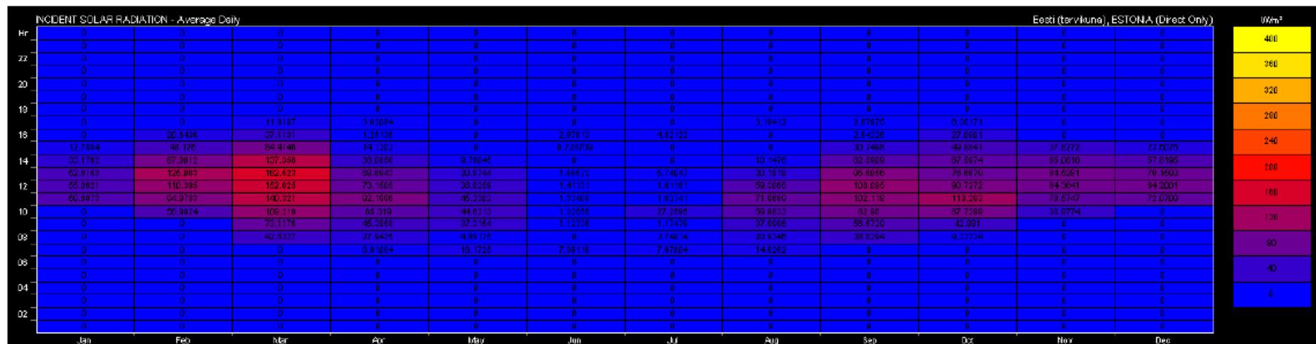
Joonis 15. Iga kuu keskmised päevase otsese päikesekiirguse hulgad (Wh/m 2 tunnis ehk W/m 2 ) akna pinna pinnaühiku kohta arhitekti poolt ette nähtud horisontaalse sirmi korral akna kohal.
