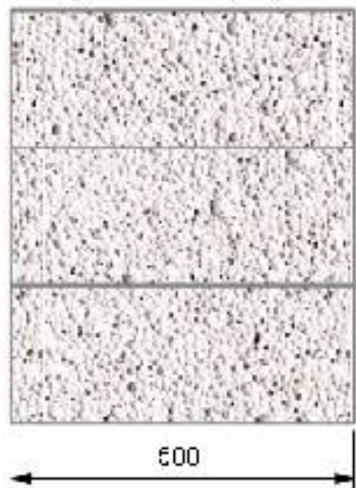
AEROC Ecolerm Plus 300 Täiskivisein (sõõrustatud) sisetel liigikaudne U-arv ≈ 0,17
