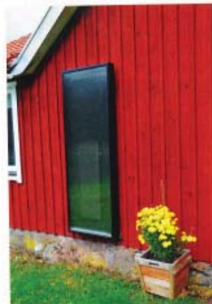
Joonis 2. Õhkküttepaneel suvila seinal
