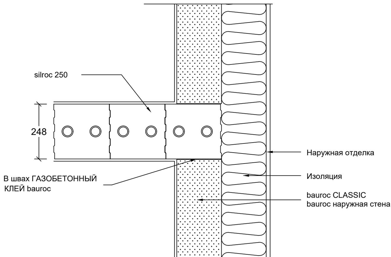
Изоляция воздушного шума стены silroc  $R'w \geq 55dB$  (со штукатуркой)
